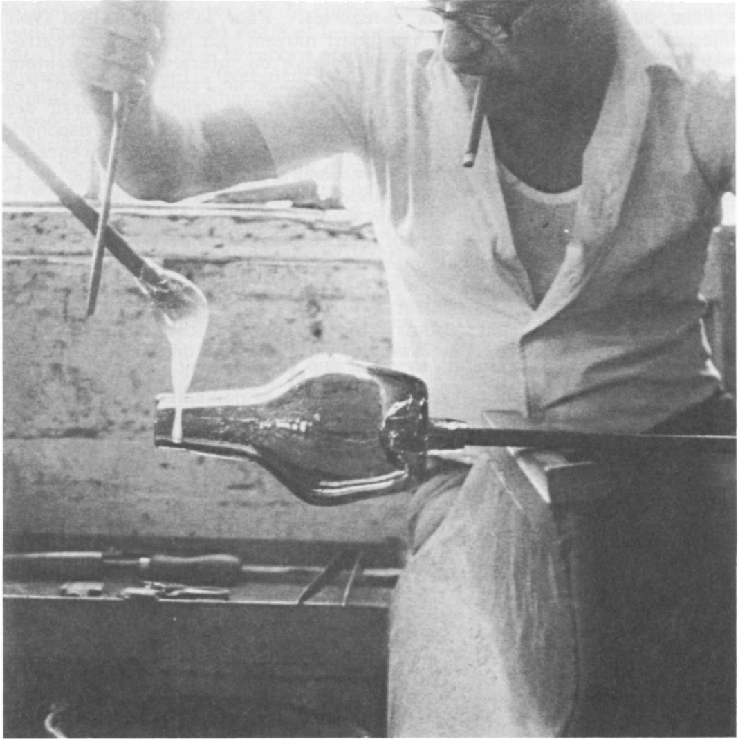
Figure 6. Un mince filet de verre est ajouté au col de la bouteille pour former la bague (Chalet Glassworks, Cornwall (Ontario). Photo: O. Jones; RA-3603M).
