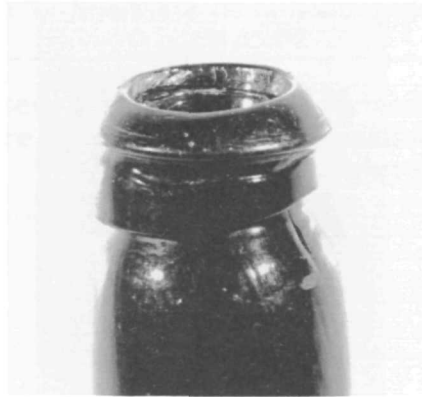
Figure 9. Le sillon horizontal apparaît sous les lignes et fissures qui marquent habituellement le bord intérieur de la surface de fissuration. Il est évident que le sillon n'a aucun rapport avec le verre ajouté pour former la lèvre (photo: G. Lupien; RA-12845B).
