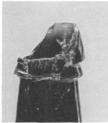
Figure 11. Ce fragment montre la ligne horizontale au-dessus des fissures et des sillons verticaux qui marquent le bord intérieur de la surface de fissuration. Sur des exemplaires dont le verre ajouté s'étend nettement au-dessus de la surface de fissuration, cette ligne se trouve généralement à plus de 10 mm du rebord de la lèvre (photo: G. Lupien; RA-1664B).
