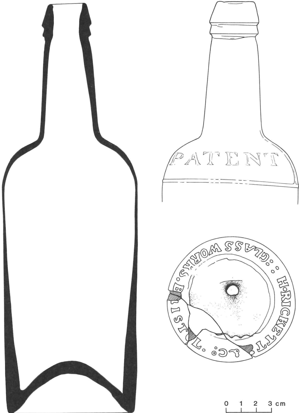
Figure 62. Souflée au moule Ricketts, cette bouteille porte à la jonction du corps et de l'épaule les marques caractéristiques du moule "en trois parties". Elle porte aussi une inscription en relief sur le cul et sur l'épaule (dessins: D. Kappler).
